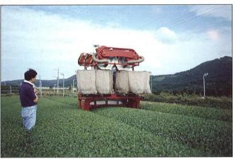
*Progressivní způsob trhání čajových listů pomocí samohybých mechanismů v prefektuře Kagošima*
